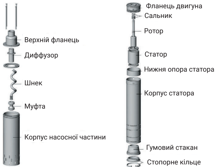
Рис. 3. Будова заглибного шнекового насосу
